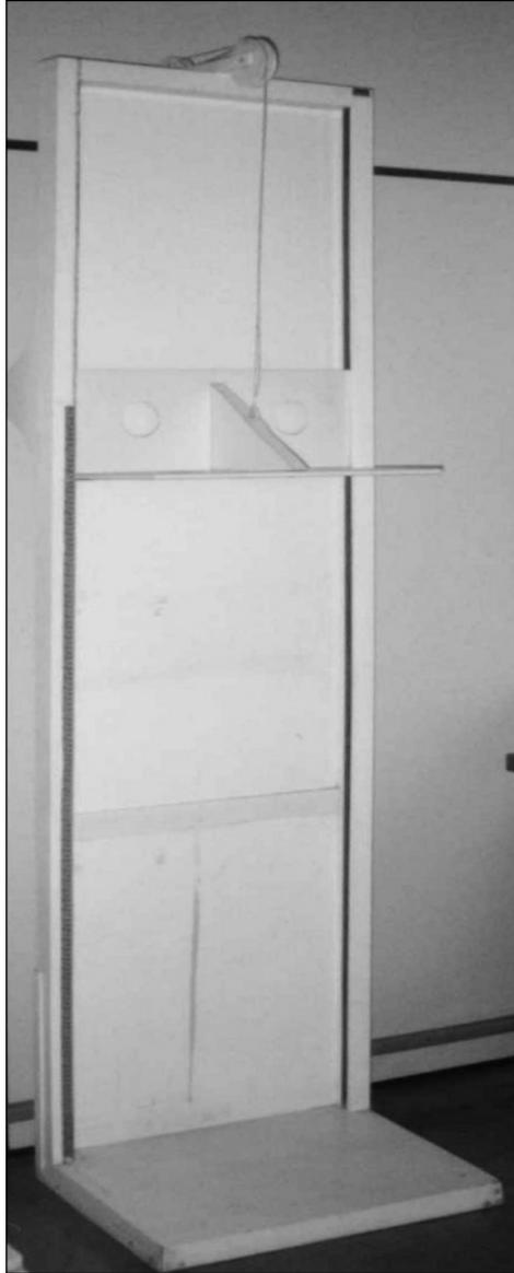
FIGURA 2: Plataforma de avaliação. Antropômetro vertical de madeira, graduado em centímetros, com esquadro móvel para o posicionamento da cabeça da criança e fita métrica de 150cm.
